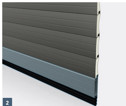
2 Profilo inferiore – profilo in alluminio di rinforzo dell'altezza 115 mm di serie verniciato in colore del manto.
