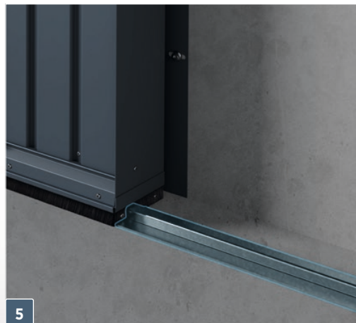
5 Binario di scorrimento inferiore – portoni sospesi scorrevoli ad un'anta dalla larghezza S_o > 6000 mm o superiori ai H_o > 4000 mm sono dotate di un binario di scorrimento inferiore supplementare. La soluzione fornisce al portone una straordinaria stabilità e riduce il carico sulla struttura dell'edificio nel sito di installazione del binario di scorrimento.
