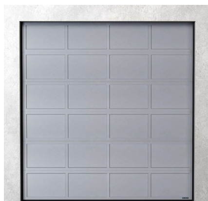
Portone MakroPro ALU 2.0 ELH con pannello in alluminio senza taglio termico con riempimento: lamiera di alluminio-polistirolo-lamiera di alluminio.
